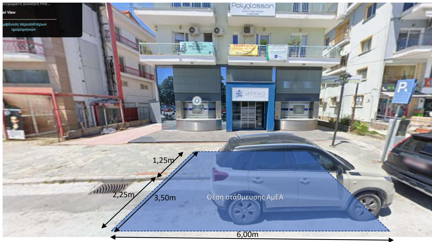
Φωτογραφική αποτύπωση προτεινόμενης θέσης στάθμευσης ΑμΕΑ
